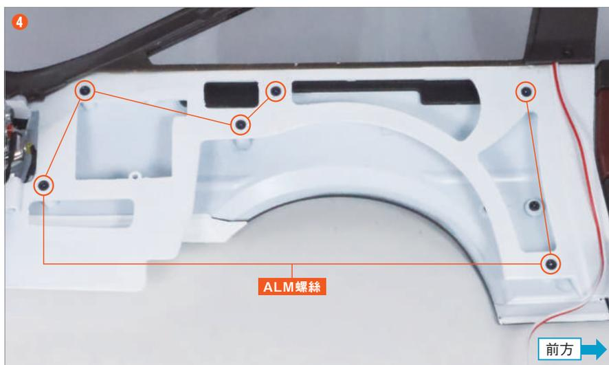
使用 0 號十字螺絲起子,從車體內側用 ALM 螺絲 將 6 個位置固定。
