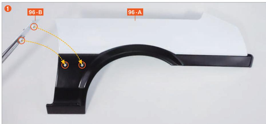
將車身側板裝飾 (L) 96-B 上的兩個螺絲孔突起，對準車身側板 (L) 96-A 上的兩個螺絲孔凹槽，並插入對接。
